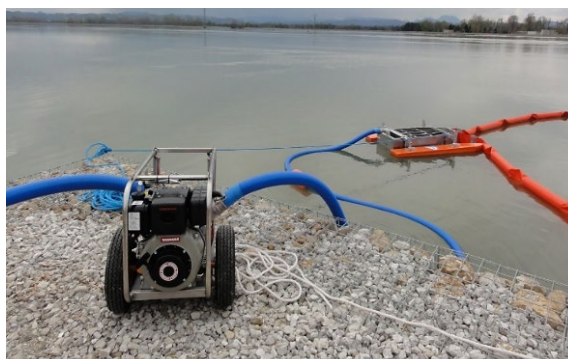
Pretočni, plavajoči posnemalec, primeren za čiščenje večjih vodotokov s hitrostjo toka do 2 m/s
